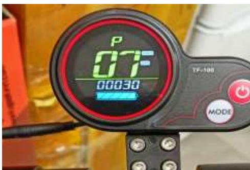
**P07 - Количество магнитов.** Отвечает за число магнитов в мотор-колесе. Задание неподходящего значения приведет к тому, что скорость вашего движения и пробег будут отображаться некорректно. Для Kugoo M2 – 30 магнитов.
