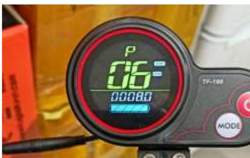
**P06 - Диаметр Колеса в дюймах.** Позволяет выбрать диаметр колеса в дюймах. У Kigoo M2 диаметр колес 8 дюймов.
