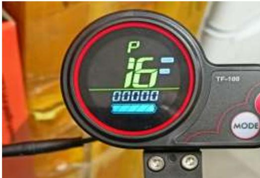
**P16 - Круиз контроль: 1 вкл, 0 выкл** Включает круиз-контроль при значении 1 или выключает его при значении 0. При установке единицы в этой настройке у вас будет автоматически включаться круиз-контроль каждый раз, когда вы будете более 6 секунд ехать с одной и той же скоростью. Режим самостоятельно выключится, стоит вам притормозить любой из ручек тормоза или же снова нажать на ручку газа
