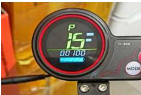
**P15 - Используемая мощность двигателя от 1 до 100%** Нужен для настройки мощности двигателя в процентах. Если на вашем самокате будет кататься ребенок или новичок, то можно установить ему не 100%, а меньше, чтобы обеспечить меньшую тягу мотора и тем самым защитить его от опасных маневров на большой скорости.
