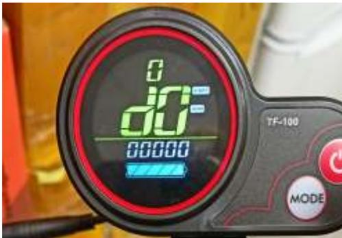
**d0 - Сброс одометра: на 6 секунд зажать MODE**
