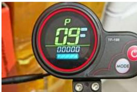
**P09 - Активность датчика отталкивания.** 1 - чтобы поехать нужно оттолкнуться, 0 - старт с места. Отвечает за активность датчика отталкивания. Если вы хотите, чтобы самокат ехал сразу по нажатию курка газа, то оставьте значение 0. При выборе единицы вам придется каждый раз для старта движения вначале толкнуться от земли, чтобы самокат набрал минимальную скорость.
